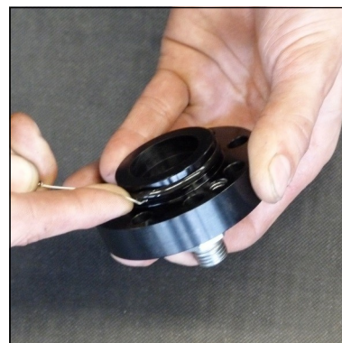
Abb. 4 - O-Ring wechseln (Deckel Kondensat-Stopp-Ventil)
