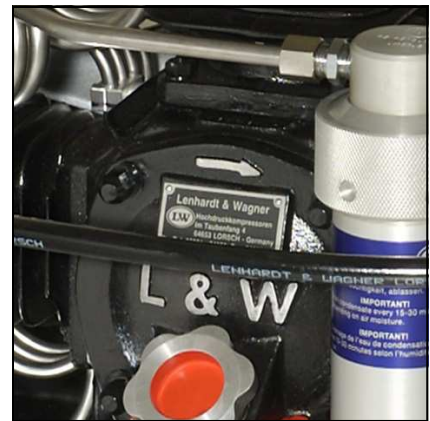
Drehrichtungspfeil auf dem Kompressorblock
