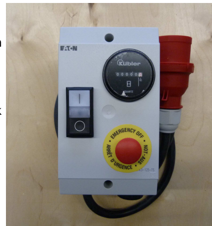
Schaltkasten mit Betriebsstundenzähler
