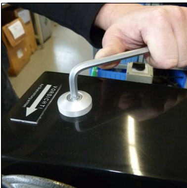
Abb. 1 - Befestigungsschraube oben entfernen
