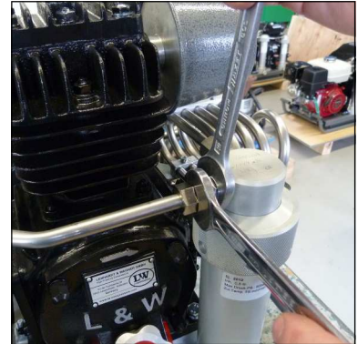
Abb. 1 - Rohrleitungsverschraubung Wasserabscheider lösen
