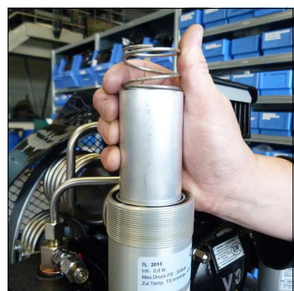
Abb. 3 - Filterpatrone und Feder
