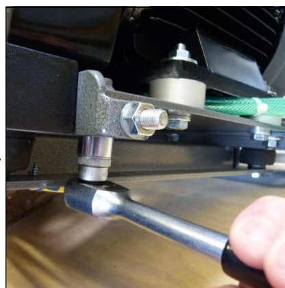
Abb. 1 - Befestigungsmuttern des Motors lösen
