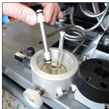
Abb. 5 - Verbindungsstutzen abziehen und O-Ringe wechseln
