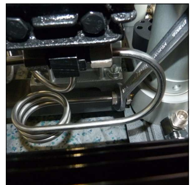
Abb. 2 - Rohrleitungsverschraubung Filtergehäuse lösen
