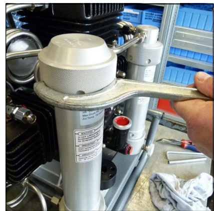
Abb. 1 - Filtergehäusedeckel mit Filterschlüssel
