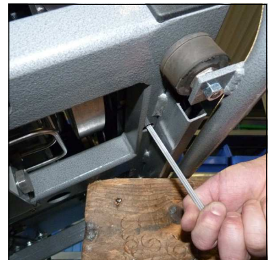
Abb. 3 - Befestigungsschrauben unten lösen
