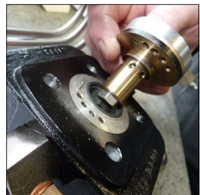
Abb. 4 - Auf Positionierung von Ventil achten (Zentrierstift)
