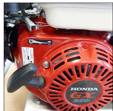
Abb. 2 - Drehzahlregulierung und Handstart
