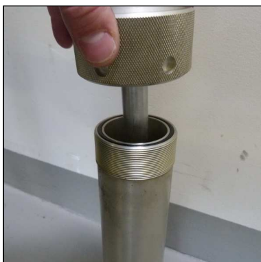
Abb. 4 - Befestigungsring entfernen und O-Ring wechseln
