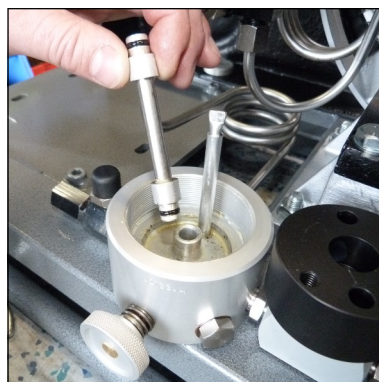
Abb. 5 - Verbindungsstutzen abziehen und O-Ringe wechseln
