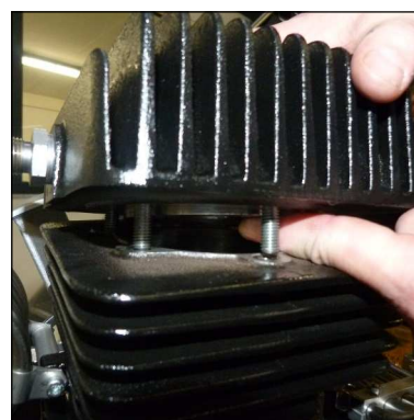
Abb. 4 - Saug-& Druckventil sichern
