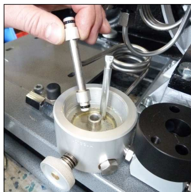
Abb. 5 - Verbindungsstutzen abziehen und O-Ringe wechseln
