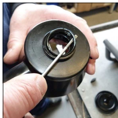
Abb. 4 - O-Ring in Zentrierbund
