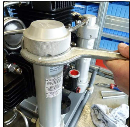
Abb. 1 - Filtergehäusedeckel mit Filterschlüssel
