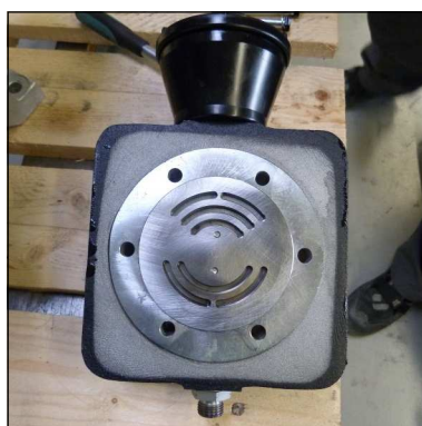
Abb. 3 - Einbauposition Saug-& Druckventil von unten
