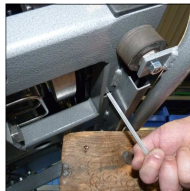
Abb. 3 - Befestigungsschrauben unten lösen
