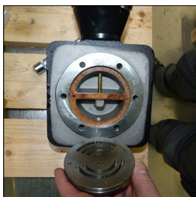
Abb. 2 - Einbauposition Saug-& Druckventil
