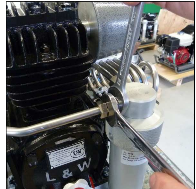
Abb. 1 - Rohrleitungsverschraubung Wasserabscheider lösen
