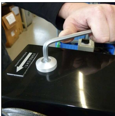
Abb. 1 - Befestigungsschraube oben entfernen
