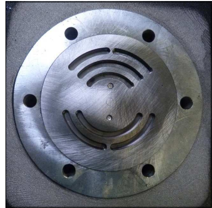
Abb. 1 - Saug – Druckventil 1. Stufe in Zylinderkopf
