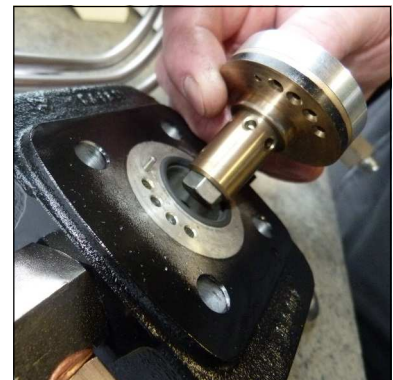
Abb. 5 - Auf Positionierung von Ventil achten (Zentrierstift)
