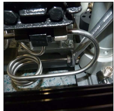
Abb. 2 - Rohrleitungsverschraubung Filtergehäuse lösen
