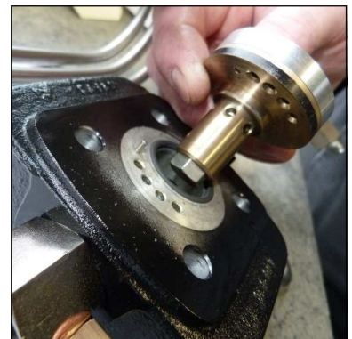
Abb. 4 - Auf Positionierung von Ventil achten (Zentrierstift)
