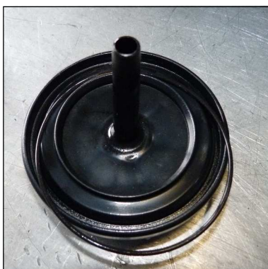
Abb. 3 - O-Ring in Gehäusedeckel
