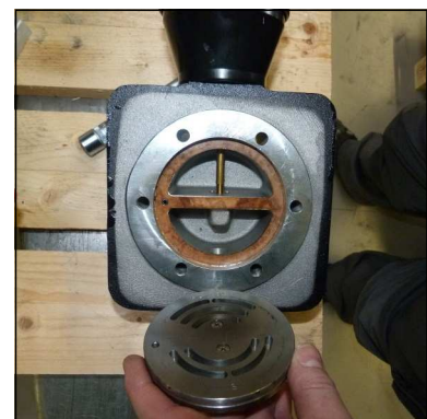
Abb. 5 - Saug- & Druckventil entnehmen
