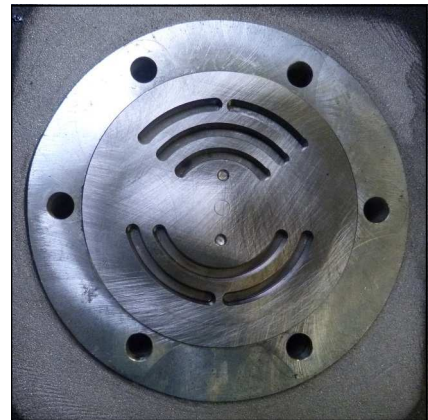
Abb. 1 - Saug – Druckventil 1. Stufe in Zylinderkopf
