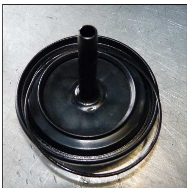
Abb. 3 - O-Ring in Gehäusedeckel
