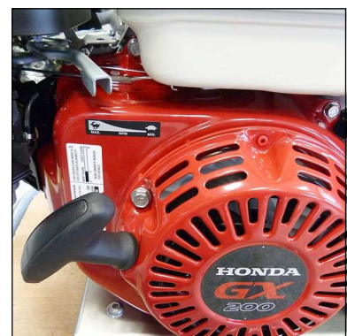
Abb. 2 - Drehzahlregulierung und Handstart
