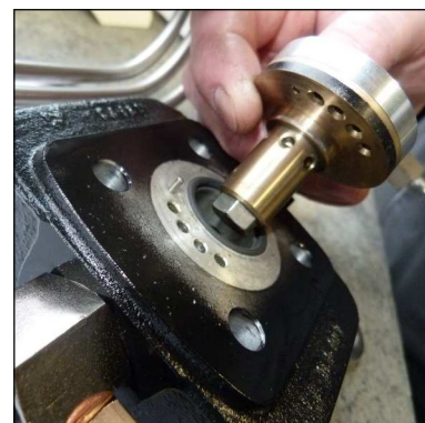
Abb. 4 - Auf Positionierung von Ventil achten (Zentrierstift)
