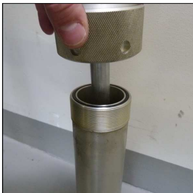
Abb. 4 - Befestigungsring entfernen und O-Ring wechseln
