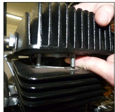
Abb. 4 - Saug-& Druckventil sichern
