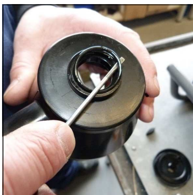
Abb. 4 - O-Ring in Zentrierbund
