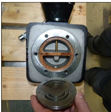
Abb. 2 - Einbauposition Saug-& Druckventil
