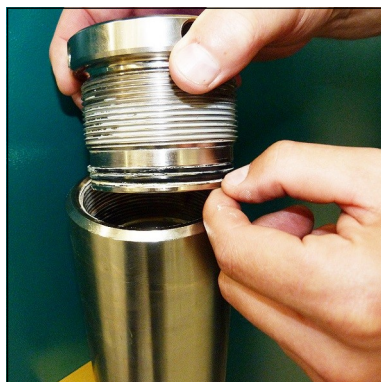
Abb. 2 - O-Ring und Stützring wechseln
