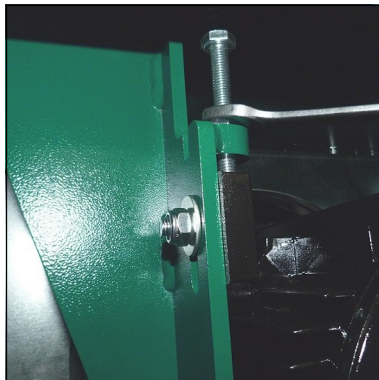
Fig. 2 - Loosen counter nut
