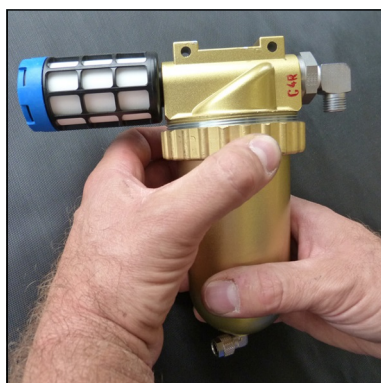
Fig. 1 - Loosen ring nut
