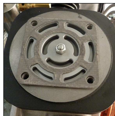
Abb. 4 - Obere Ventildichtung ausgerichtet auflegen
