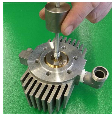
Abb. 4 - Saug / Druckventil ausbauen
