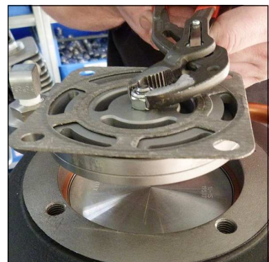
Abb. 2 - Saug- / Druckventil herausziehen
