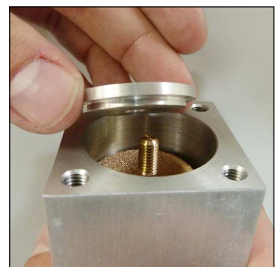
Abb. 5 - Filterscheibe und Unterlegscheibe aufsetzen
