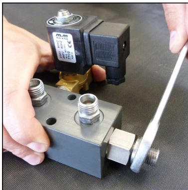
Abb. 2 - Gerade Verschraubung lösen
