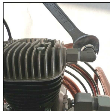
Abb. 6 - Rohrleitungsverschraubung anschließen und anziehen
