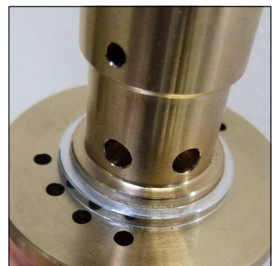
Abb. 5 - Auf korrekte Einbauposition des oberen Ventildichtrings achten
