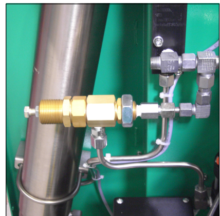
Abb. Druckminderer: 330 / 225 bar
