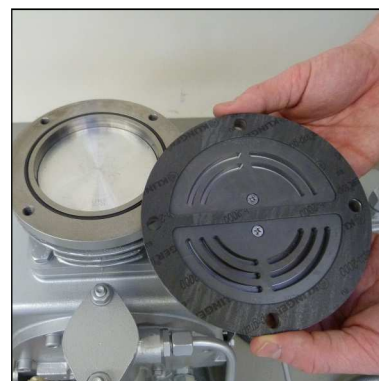
Abb. 2 - Einbauposition der oberen Ventildichtung
