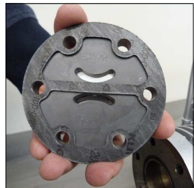
Abb. 2 - Einbauposition der oberen Ventildichtung
