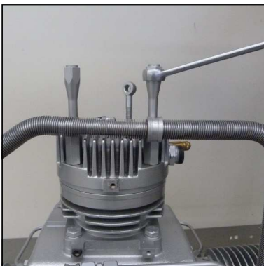
Abb. 5 - Obere Kühlrohrhalterung entfernen
