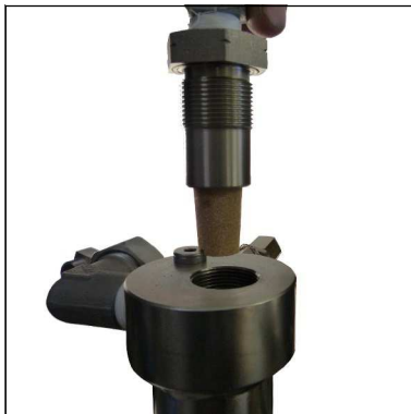
Abb. 2 - Halter für Sinterfilter entnehmen
