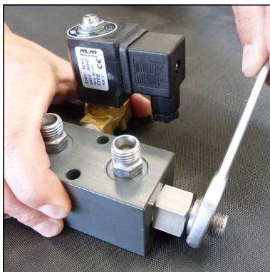
Abb. 2 - Gerade Verschraubung lösen
