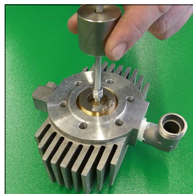
Abb. 4 - Saug / Druckventil ausbauen
