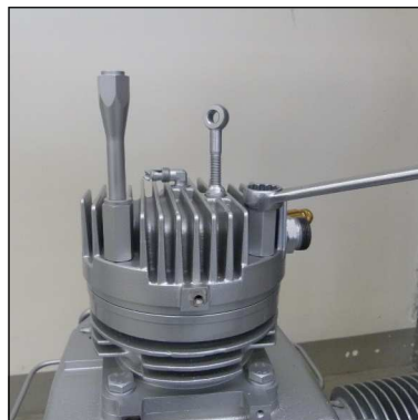
Abb. 6 - Untere Kühlrohrhalterung entfernen
