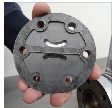
Abb. 2 - Einbauposition der oberen Ventildichtung
