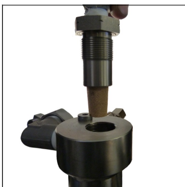
Abb. 2 - Halter für Sinterfilter entnehmen
