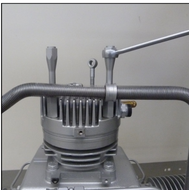
Abb. 5 - Obere Kühlrohrhalterung entfernen
