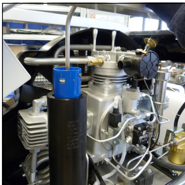
Abb. 2 - Filterpatrone mit Filterschlüssel entnehmen
