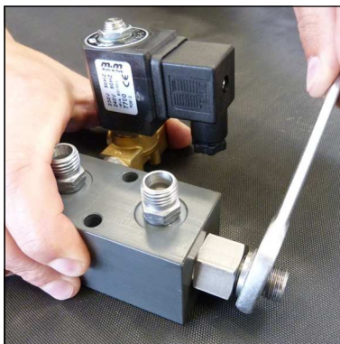
Abb. 2 - Gerade Verschraubung lösen
