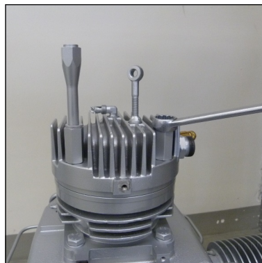
Abb. 6 - Untere Kühlrohrhalterung entfernen
