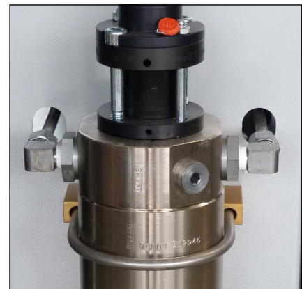
Abb. 1 - Rohrleitungsverschraubungen und Muttern lösen
