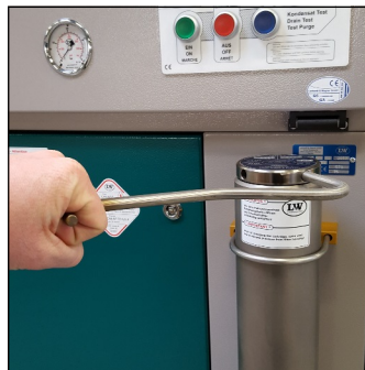
Abb. 2 - Abschrauben des Filtergehäuse-Deckels
