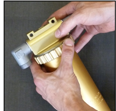
Abb. 1 - Gewinding öffnen und Oberteil abnehmen
