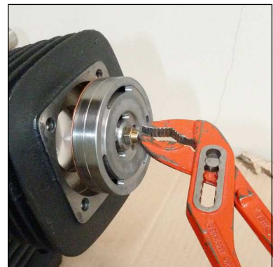
Abb. 2 - Saug- / Druckventil herausziehen
