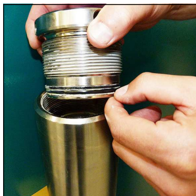
Abb. 2 - O-Ring und Stützring wechseln
