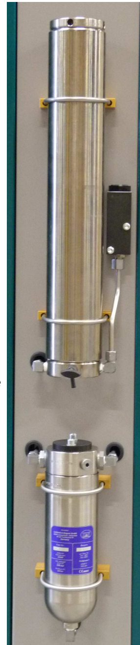
Filtergehäuse 1.7l (oben), Druckhalte-Rückschlagventil u. Partikelfiltergehäuse 0,8l mit Sicherheitsventil
