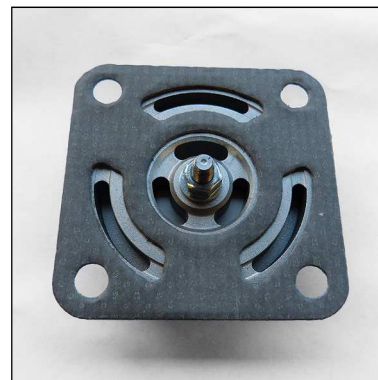
Abb. 4 - Auf korrekte Platzierung der Papierdichtung achten!
