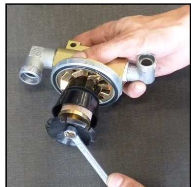
Abb. 2 - Mutter am Oberteil lösen
