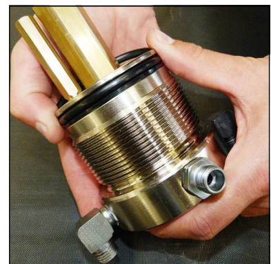
Abb. 4 - O-Ring und Stützring wechseln
