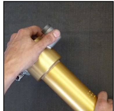
Abb. 1 - Oberteil abschrauben und abnehmen
