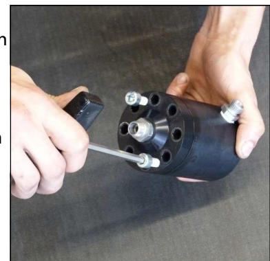
Abb. 2 - Kondensat-Stopp-Ventil-Oberteil abziehen
