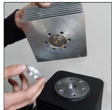
Abb. 2 - Untere Ventildichtung entfernen
