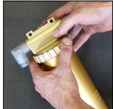
Abb. 1 - Gewinding öffnen und Oberteil abnehmen
