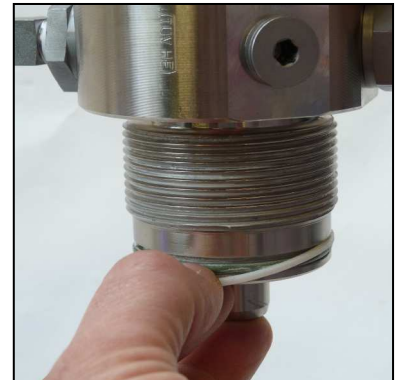
Abb. 2 - O-Ring und Stützring wechseln
