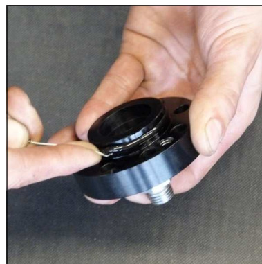
Abb. 4 - O-Ring wechseln (Deckel Kondensat-Stopp-Ventil)
