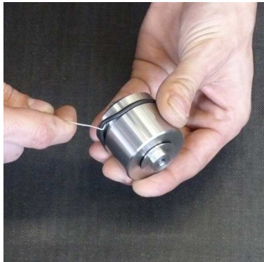
Abb. 4 - O-Ring wechseln am Kondensat-Stopp-Ventil
