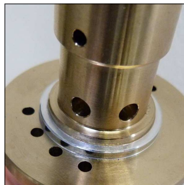
Abb. 4 - Auf korrekte Einbauposition des oberen Ventildichtrings achten
