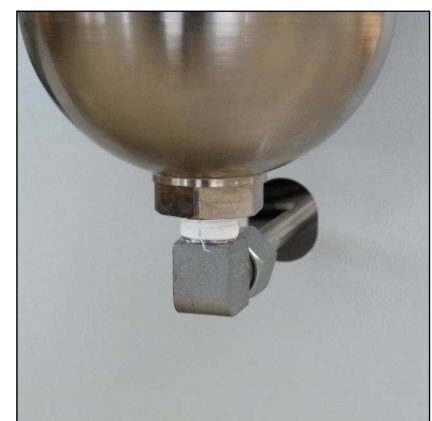
Abb. 2 - Rohrleitungsverschraubungen und Muttern lösen
