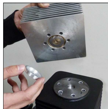
Abb. 2 - Untere Ventildichtung entfernen
