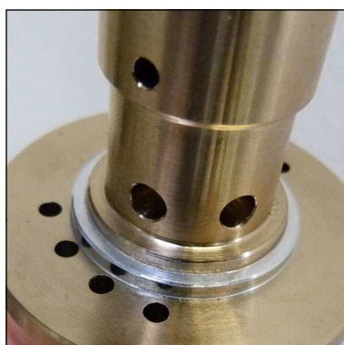
Abb. 4 - Auf korrekte Einbauposition des oberen Ventildichtrings achten
