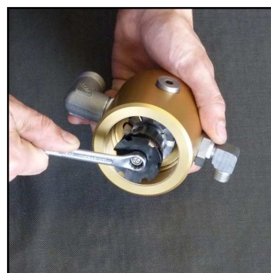
Abb. 2 - Mutter am Oberteil lösen
