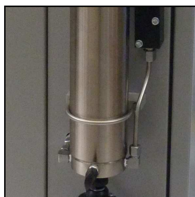
Abb. 3 - Rohrleitungsverschraubungen und Muttern lösen
