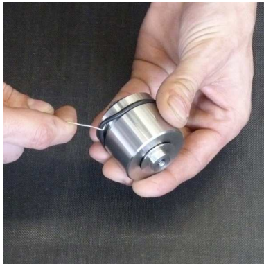
Abb. 4 - O-Ring wechseln am Kondensat-Stopp-Ventil
