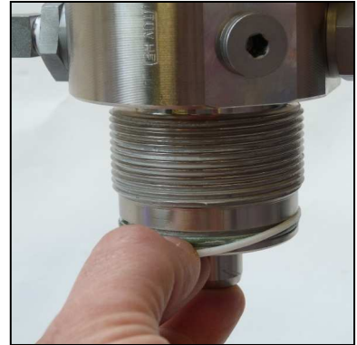
Abb. 2 - O-Ring und Stützring wechseln
