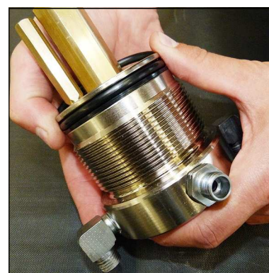
Abb. 4 - O-Ring und Stützring wechseln
