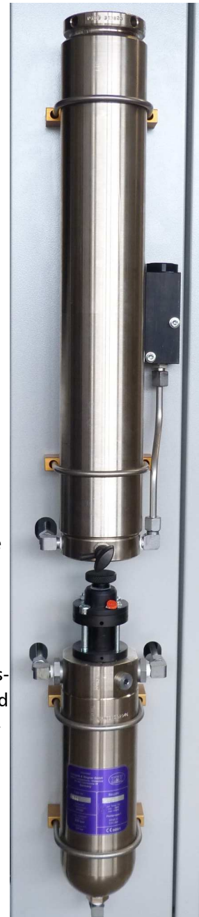
Filtergehäuse 1.7l (oben), Druckhalte-Rückschlagventil u. Partikelfiltergehäuse 0,8l mit Sicherheitsventil (unten)
