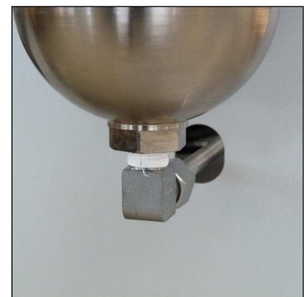
Abb. 2 - Rohrleitungsverschraubungen und Muttern lösen
