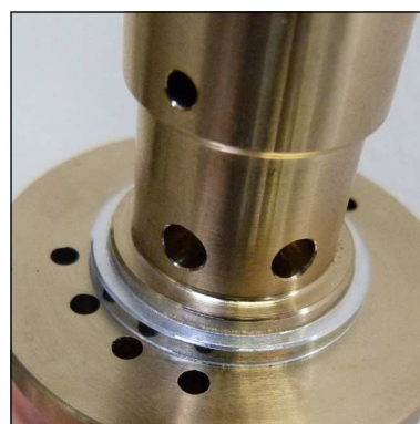
Abb. 4 - Auf korrekte Einbauposition des oberen Ventildichtrings achten
