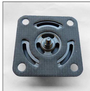
Abb. 4 - Auf korrekte Platzierung der Papierdichtung achten!
