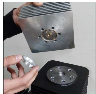
Abb. 2 - Untere Ventildichtung entfernen
