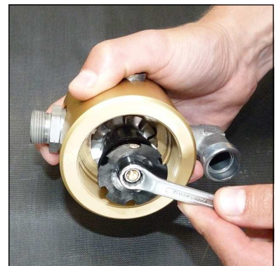
Abb. 2 - Mutter am Oberteil lösen
