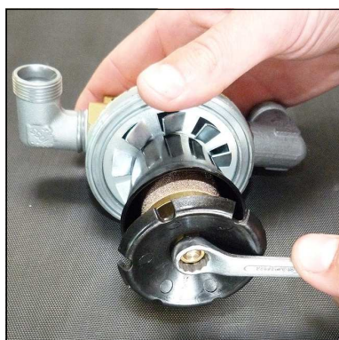
Abb. 2 - Mutter am Oberteil lösen
