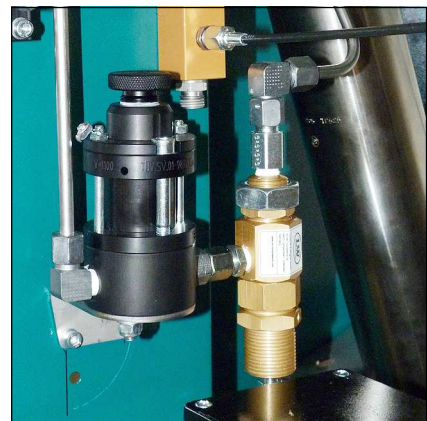
Abb. links Sicherheitsventil: 225 bar, rechts Druckminderer: 330 / 225 bar
