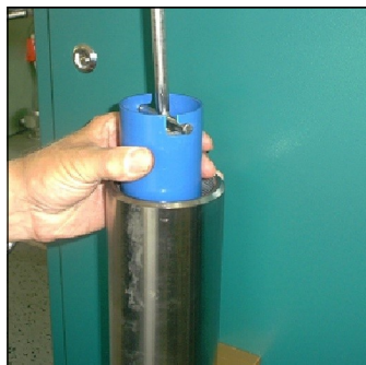
Abb. 4 - Filterpatrone aus dem Gehäuse entnehmen
