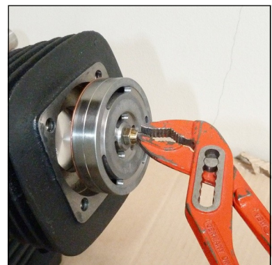
Abb. 2 - Saug- / Druckventil herausziehen
