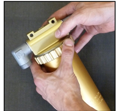
Abb. 1 - Gewinding öffnen und Oberteil abnehmen
