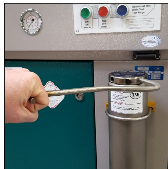
Abb. 2 - Abschrauben des Filtergehäuse-Deckels
