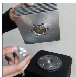
Abb. 2 Untere Ventildichtung entfernen
