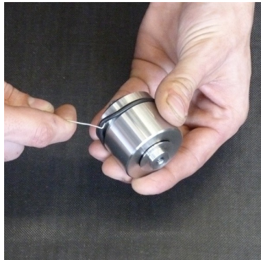
Abb. 4 - O-Ring wechseln am Kondensat-Stopp-Ventil
