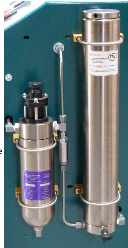
Filtergehäuse 1,7l (rechts), Partikelfiltergehäuse 0,8l mit Sicherheitsventil (links)
