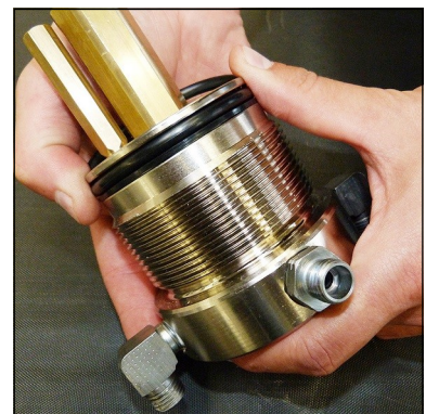
Abb. 4 - O-Ring und Stützring wechseln
