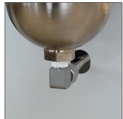
Abb. 2 - Rohrleitungsverschraubungen und Muttern lösen
