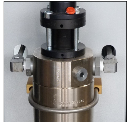
Abb. 1 - Rohrleitungsverschraubungen und Muttern lösen
