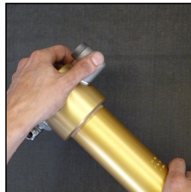
Abb. 1 - Oberteil abschrauben und abnehmen
