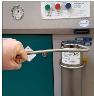
Abb. 2 - Abschrauben des Filtergehäuse-Deckels
