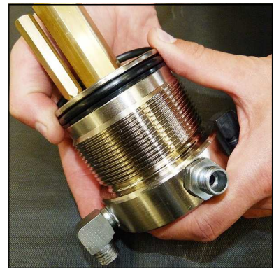
Abb. 4 - O-Ring und Stützring wechseln
