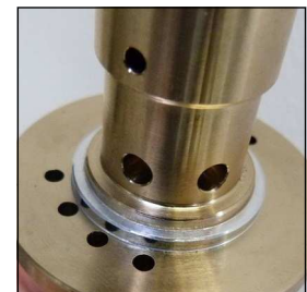
Abb. 4 Auf korrekte Einbauposition des oberen Ventildichtrings achten
