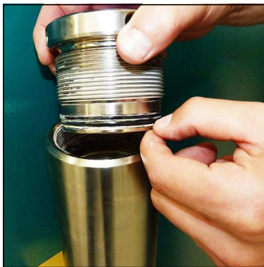
Abb. 2 - O-Ring und Stützring wechseln
