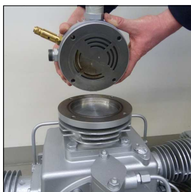
Abb. 3 - Einbauposition der Ventilplatte mit Ventilkopf
