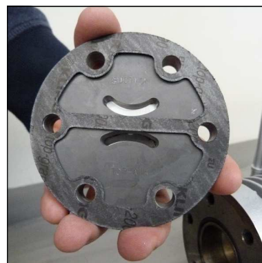
Abb. 2 - Einbauposition der oberen Ventildichtung
