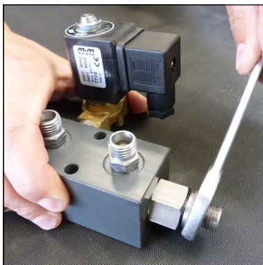
Abb. 2 - Gerade Verschraubung lösen
