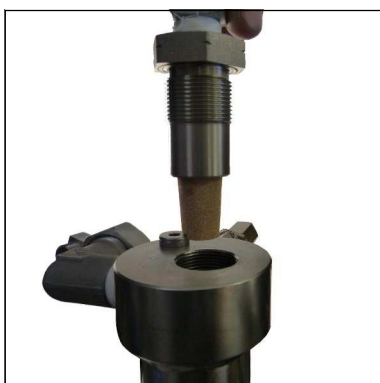
Abb. 2 - Halter für Sinterfilter entnehmen
