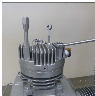
Abb. 6 - Untere Kühlrohrhalterung entfernen
