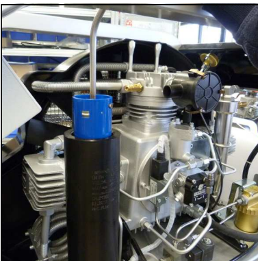
Abb. 2 - Filterpatrone mit Filterschlüssel entnehmen
