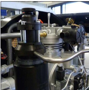
Abb. 1 - Filtergehäusedeckel mit Filterschlüssel öffnen
