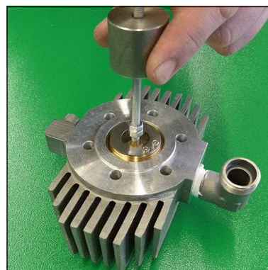
Abb. 4 - Saug / Druckventil ausbauen
