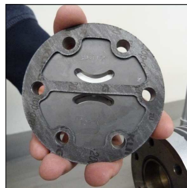
Abb. 2 - Einbauposition der oberen Ventildichtung
