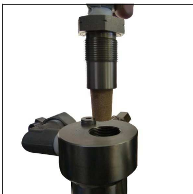
Abb. 2 - Halter für Sinterfilter entnehmen
