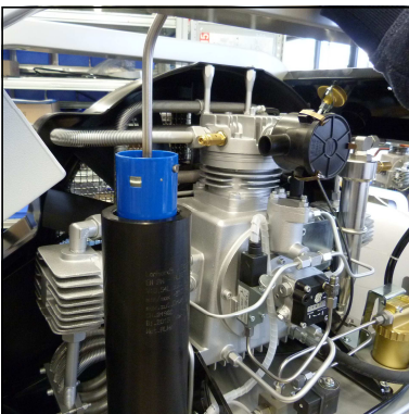
Abb. 2 - Filterpatrone mit Filterschlüssel entnehmen
