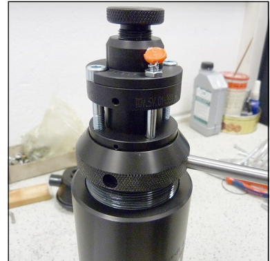
Abb. 1 - Filterdeckel abdrehen/ eindreuen
