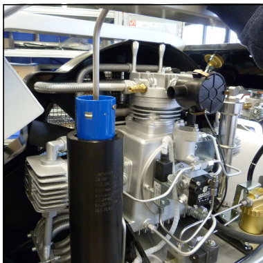
Abb. 2 - Filterpatrone mit Filterschlüssel entnehmen
