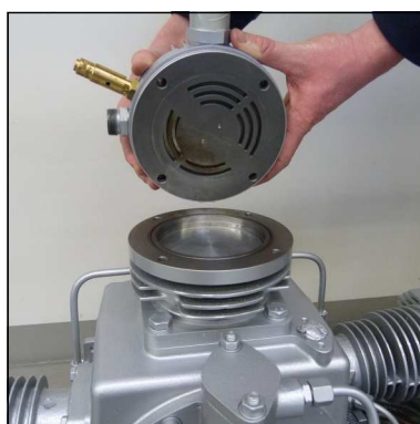
Abb. 3 - Einbauposition der Ventilplatte mit Ventilkopf
