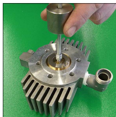
Abb. 4 - Saug / Druckventil ausbauen
