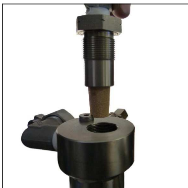
Abb. 2 - Halter für Sinterfilter entnehmen
