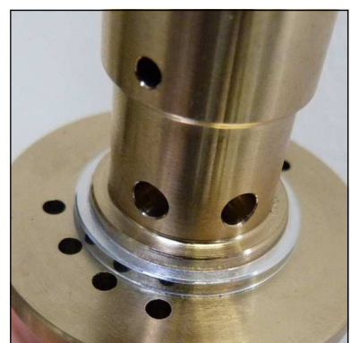
Abb. 5 - Auf korrekte Einbauposition des oberen Ventildichtrings achten
