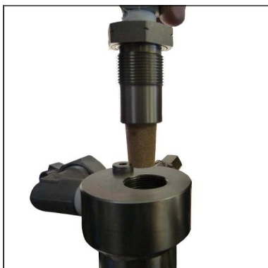
Abb. 2 - Halter für Sinterfilter entnehmen
