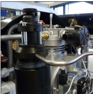
Abb. 1 - Filtergehäusedeckel mit Filterschlüssel öffnen
