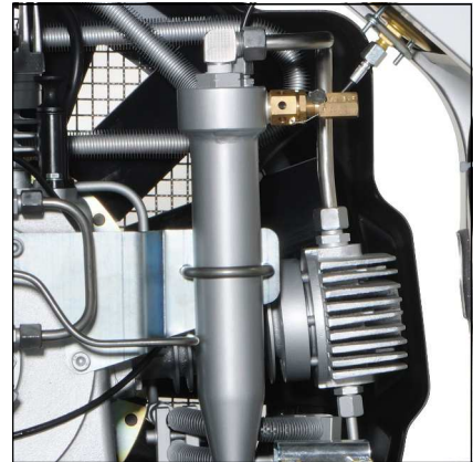
Abb. 1 - Öl- / Wasserabscheider 2. Stufe
