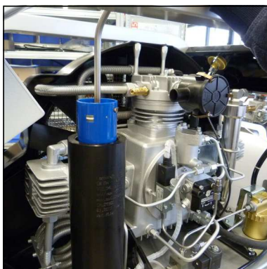
Abb. 2 - Filterpatrone mit Filterschlüssel entnehmen
