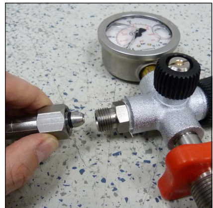
Abb. 2 - O-Ring am Füllschlauch
