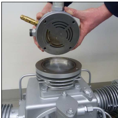
Abb. 3 - Einbauposition der Ventilplatte mit Ventilkopf
