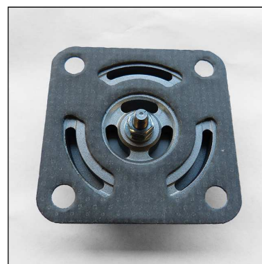
Abb. 4 - Auf korrekte Platzierung der Papierdichtung achten!
