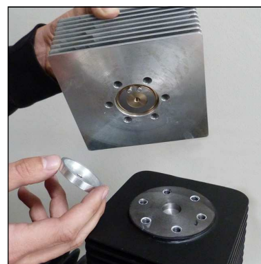
Abb. 2 - Untere Ventildichtung entfernen
