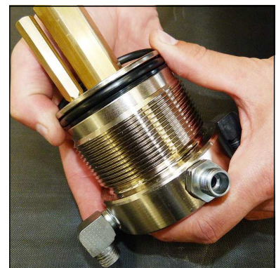
Abb. 4 - O-Ring und Stützring wechseln
