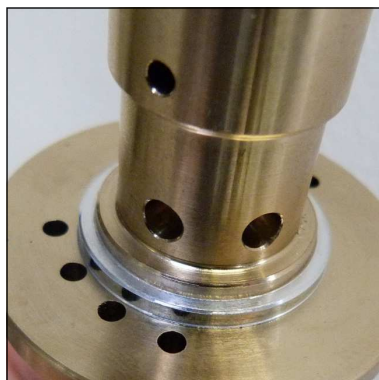
Abb. 4 - Auf korrekte Einbauposition des oberen Ventildichtrings achten
