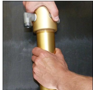
Abb. 1 - Oberteil abschrauben und abnehmen
