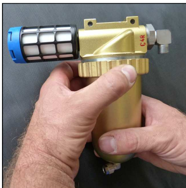
Fig. 1 - Loosen ring nut
