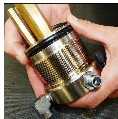
Abb. 4 - O-Ring und Stützring wechseln
