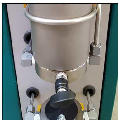
Abb. 3 - Rohrleitungsverschraubungen und Muttern lösen
