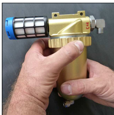
Fig. 1 - Loosen ring nut
