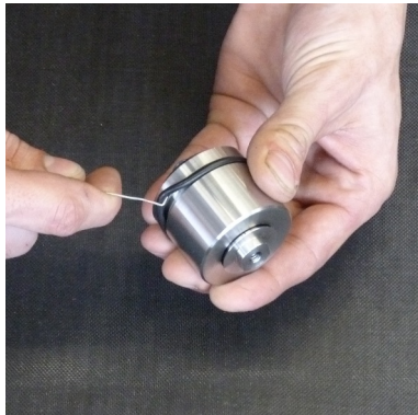
Abb. 4 - O-Ring wechseln am Kondensat-Stopp-Ventil
