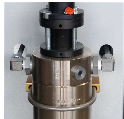
Abb. 1 - Rohrleitungen und Muttern lösen
