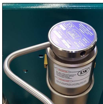
Abb. 2 - Abschrauben des Filtergehäuse-Deckels
