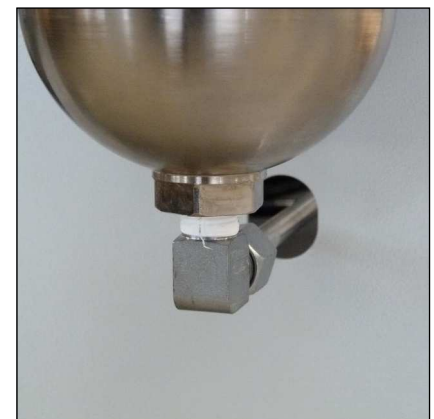
Abb. 2 - Rohrleitungen und Muttern lösen
