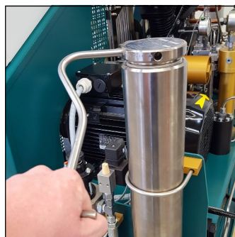
Abb. 2 - Abschrauben des Filtergehäuse-Deckels
