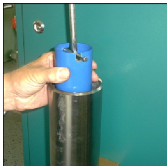
Abb. 4 - Filterpatrone aus dem Gehäuse entnehmen
