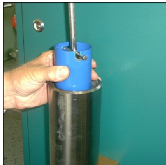
Abb. 4 - Filterpatrone aus dem Gehäuse entnehmen
