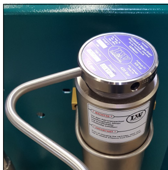
Abb. 2 - Abschrauben des Filtergehäuse-Deckels
