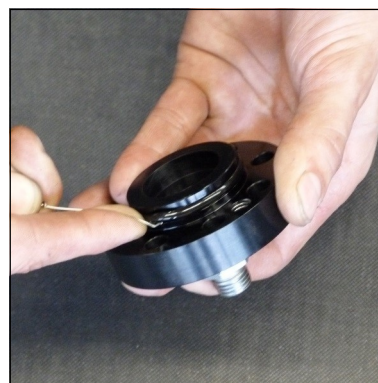
Abb. 4 - O-Ring wechseln (Deckel Kondensat-Stopp-Ventil)
