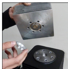
Abb. 2 Untere Ventildichtung entfernen
