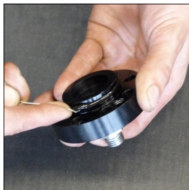
Abb. 4 - O-Ring wechseln (Deckel Kondensat-Stopp-Ventil)
