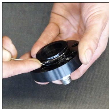
Abb. 4 - O-Ring wechseln (Deckel Kondensat-Stopp-Ventil)
