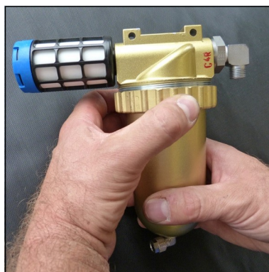
Fig. 1 - Loosen ring nut
