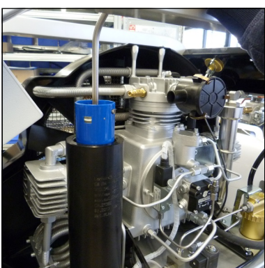
Abb. 2 - Filterpatrone mit Filterschlüssel entnehmen
